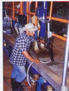
**1.** Empieza con el ordeño higiénico en la finca, luego la leche es almacenada en el tanque de frío y se traslada a la planta en el carrotanque refrigerado, donde se conserva a una temperatura de 4°C.
