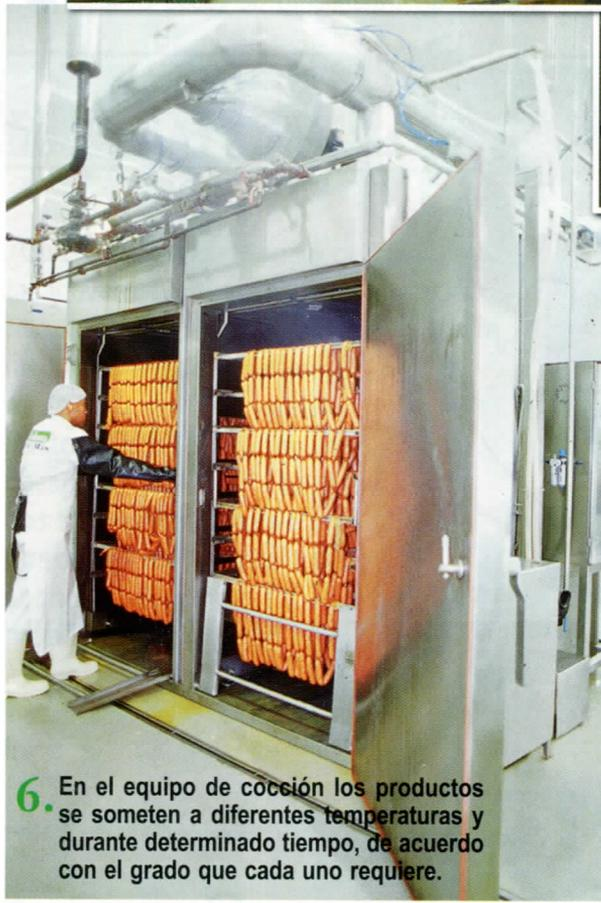
6. En el equipo de cocción los productos se someten a diferentes temperaturas y durante determinado tiempo, de acuerdo con el grado que cada uno requiere.
