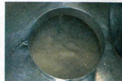
**3 HIDRÓLISIS:** Se adiciona a la leche una enzima (lactasa) con el fin de evitar la formación de cristales, que son perceptibles en el paladar y le imprimen una arenosidad muy desagradable al producto.
