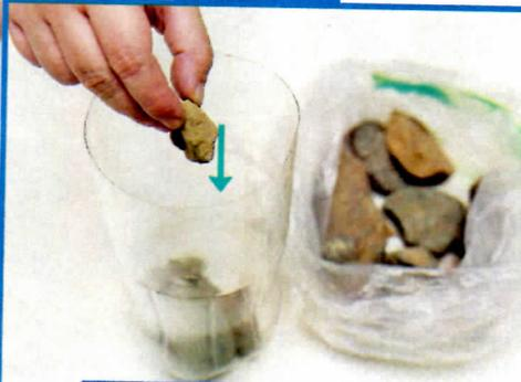
Introduce algunas piedras en la parte inferior de la botella, para nivelar la base y evitar que el viento la voltee. Toma un marcador y una regla de borde recto para dibujar una línea horizontal sobre las piedras. Esa es la parte inferior del pluviómetro.
