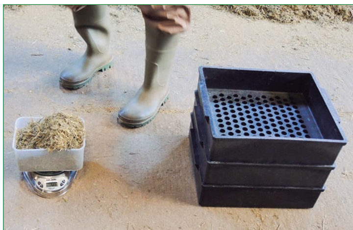
Figura 1. Análisis del picado y porcentajes de fibra en la mezcla con una caja separadora de partículas de la universidad de Pensilvania
