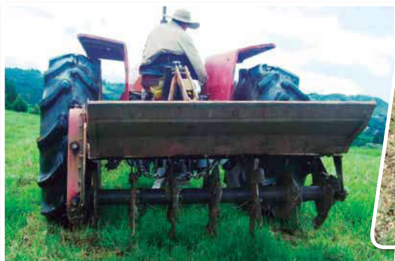
Figura 3. Rotavator de Cuchilla Lineal. Foto: Jorge M. Noreña G.
