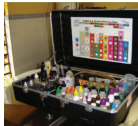
Gráfica 4. Kit para determinar calidad físico-química del agua.
