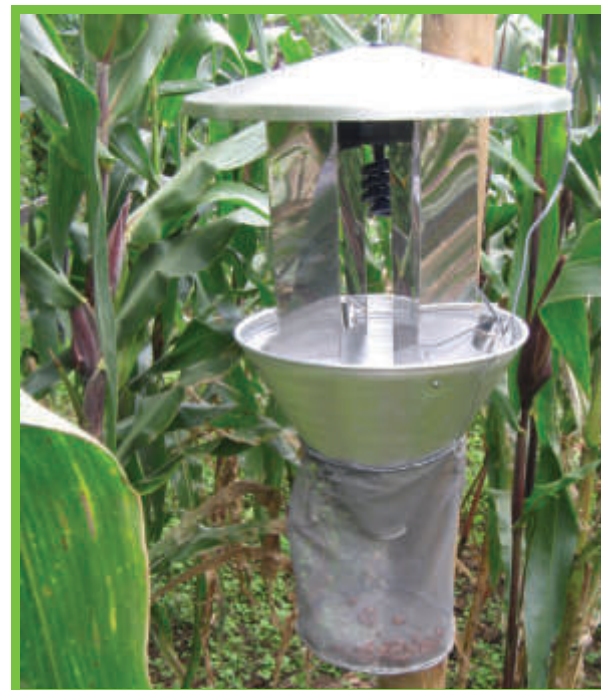
Figura 8. Trampa de luz azul negra con anejo para recoger en seco los marceños capturados.
