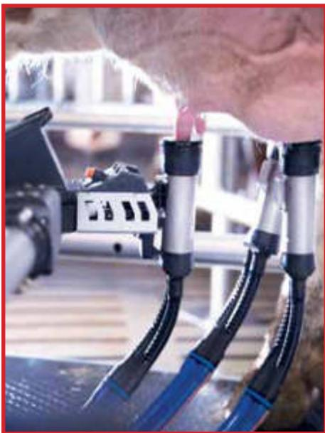
el sistema de contención, proceso de detección de pezones, brazo robótico para la colocación de las pezoneras, sistemas de limpieza de pezones, sistema de sensores y software propio del equipo de ordeño, y claro está, su propio sistema de lavado automático.
