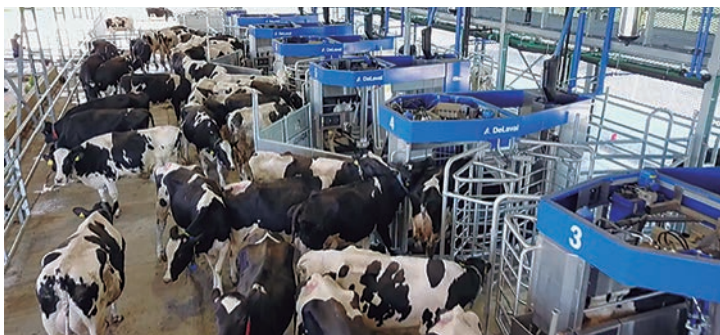
Figura 6. Ordeño robotizado por lotes, con los robots a lo largo del corral de espera (Fuente: DeLaval)
