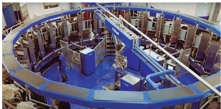
Figura 3. Brazos robotizados independientes en una sala rotativa.
