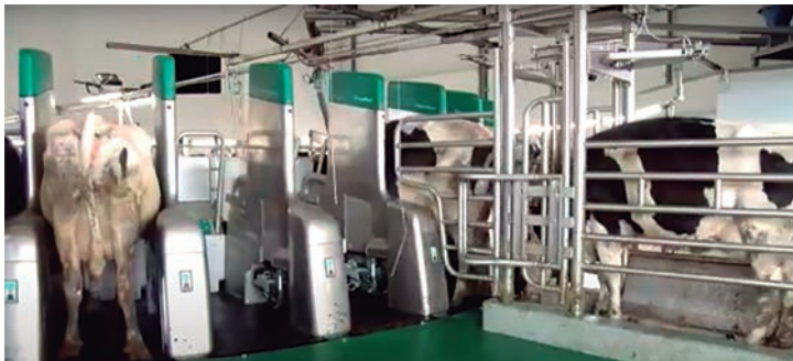
Figura 4. Sala rotativa con un brazo robotizado en cada plaza
