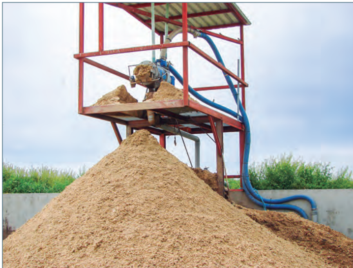
Figura 7. Separador mecánico sólido-líquido y sólido generado
