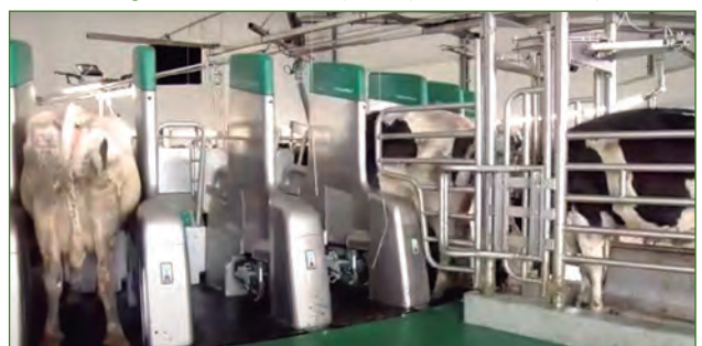
Figura 5. Ordeño robotizado por lotes, con los robots a lo largo del corral de espera (Fuente: DeLaval)
