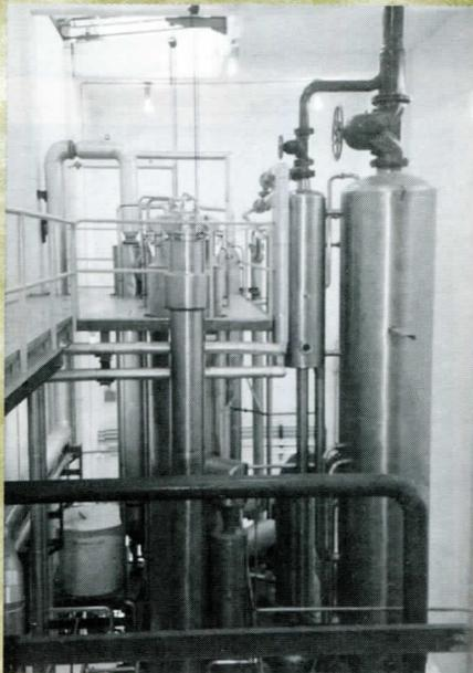
**En** las diferentes fases del evaporador, la leche va perdiendo del 80 al 85% del agua total en un sistema hermético y calentado por medio de vapor. La leche entera que entraba con 12.5% de sólidos (lactosa, proteínas, grasa y minerales), sale convertida en un concentrado de aproximadamente 47 ó 48% de sólidos totales.
