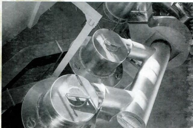
**En** esta área encontramos los ciclones, destinados a regular el aire que sale de la cámara, apartando el polvo. "El aire sale a la atmósfera por medio de ventiladores de extracción. Se dispone también de los vibrofluidizadores encargados del transporte, post-secado, fluidización y enfriamiento del polvo que resulta".
